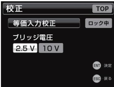
ひずみゲージ式トランスジューサーに供給するブリッジ電圧を選択します。
