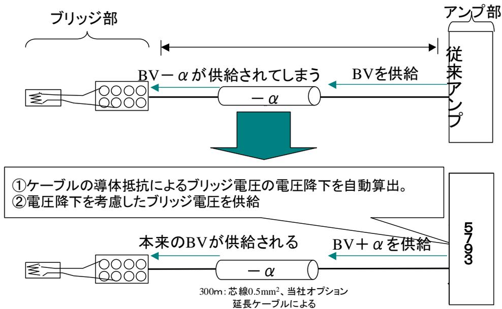
図 3-5 線長補正機能の概略図
