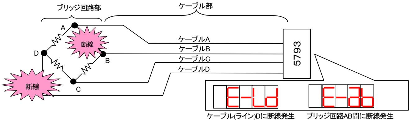
図 3-3 断線チェックの概略図
