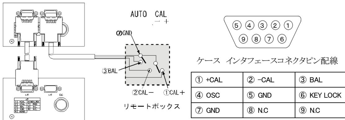
図 3-10 リモートボックスの概略図
