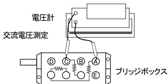
図 4-11 ブリッジ部の電圧測定
