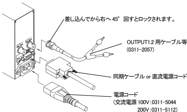
図 3-2 電源、出力ケーブルの接続
